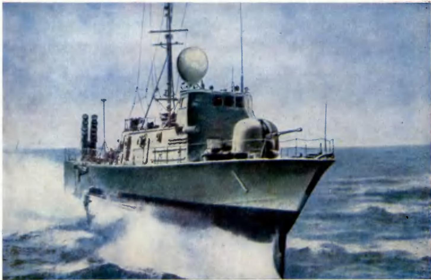
\* АМЕРИКАНСКИЙ РАКЕТНЫЙ КАТЕР НА ПОДВОДНЫХ КРЫЛЬЯХ РНМ1 «ПЕГАС». Водоизмещение полное 221 т; длина 40 м, ширина 28,2 м, осадка 1,9 м (в водоизмещающем режиме); мощность газовой турбины 18 000 л. с. (скорость хода 40 уз), мощность двух дизелей 1600 л. с. (скорость хода 12 уз); вооружение: система УРО «Гарпун» (восемь направляющих), 76-мм башенная арт-установка. Экипаж 21 человек, из них четыре офицера
